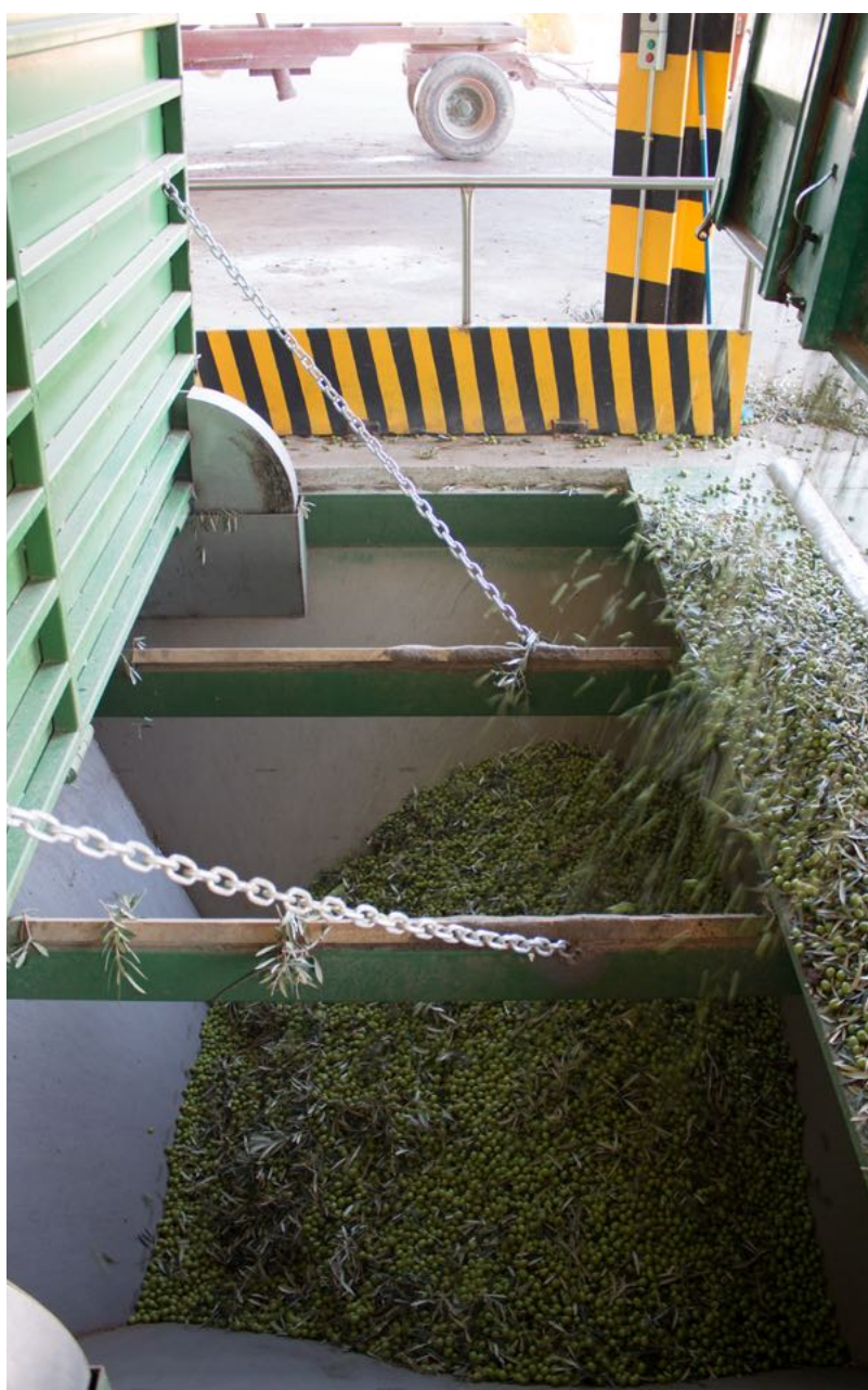
San José de Lora de Estepa S.C.A. ha procedido a la renovación de una de las tolvas de descarga
