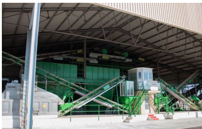
La Purísima de Herrera S.C.A. ha realizado una renovación de su patio, además de instalar una nueva tolva de descarga y renovar algunas de las cintas de transporte de la aceituna.
