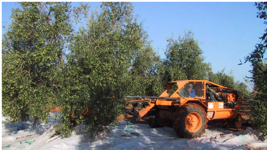
Foto 1. Equipo mecánico autopulsado tipo “buggy”
