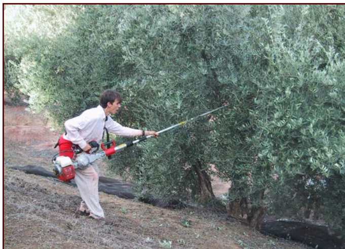
Foto 2. Equipo de mecánico de vibración unidireccional con accionamiento sistema biela-manivela mediante motor de gasolina
